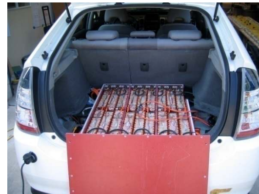
PHEV 자동차 충전용 배터리 장착 예
